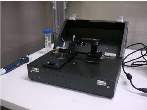
図 3 1 万画素および 6.5 万画素イオンイメージセンサ読み出し装置
