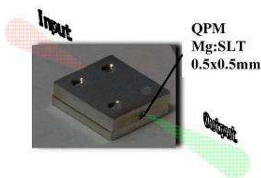
図9 高排熱波長変換モジュール
