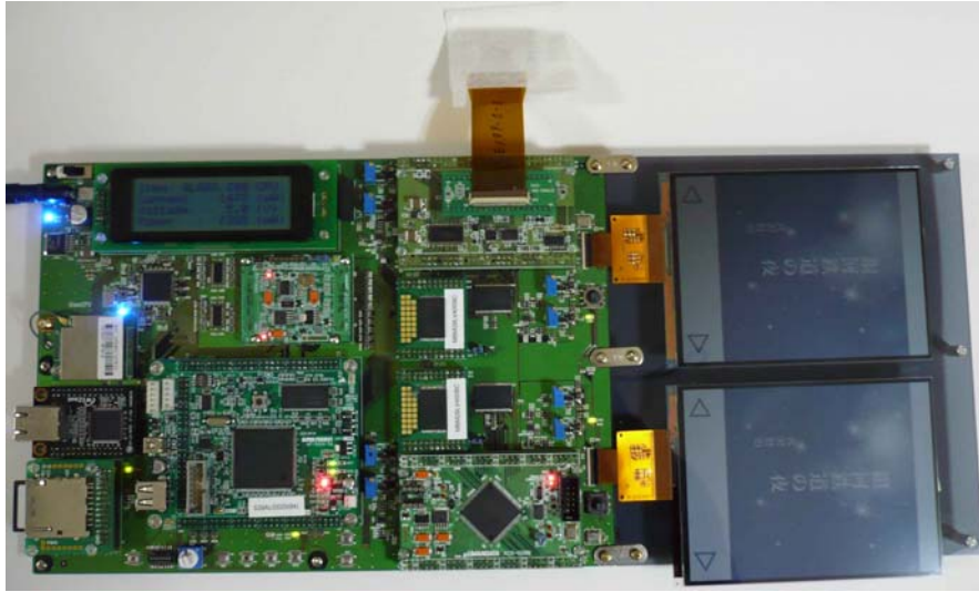
図2 電子ブックをガラス基板上 MPU(Z80)と FPGA で駆動した時の消費電力を比較するデモ機
