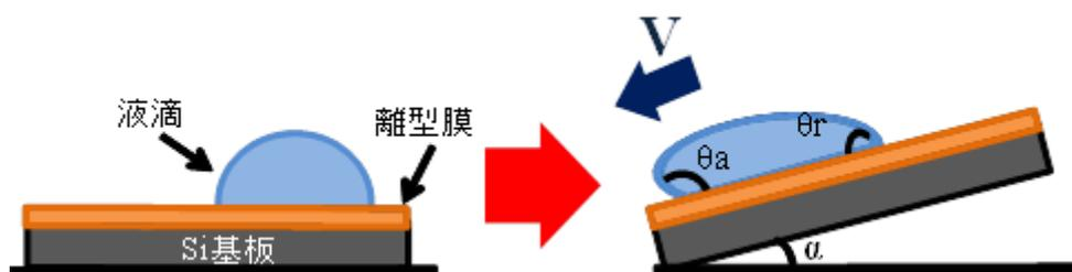
図 1 滑落法の模式図
