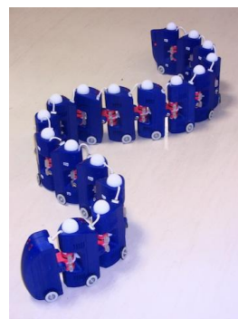
図2 ヘビ型ロボット (Haubot 2)
