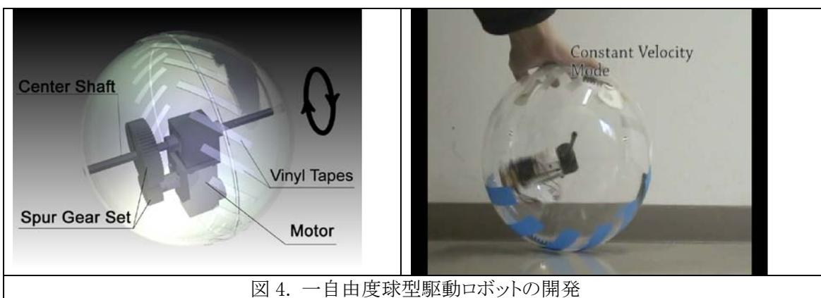
図 4. 一自由度球型駆動ロボットの開発
