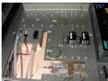
図8 単一モードと偏波保持ファイバー(コア径25 $\mu$ m)による1,2段目増幅部
