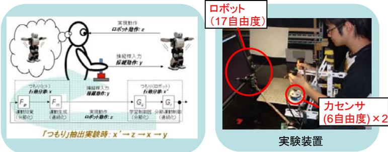
図 阪大-5 「つもり」の抽出によるロボット操縦支援実験
