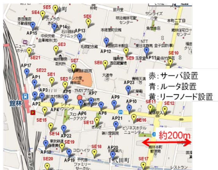
図 3 群馬県館林市に設置した微気象センサ
