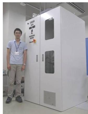
40℃の範囲で、窒素希釈した 1~20%のフッ素ガスを反応容器に導入し、有機化合物の水素原子をフッ素原子に置換することができる。その性能評価をポリスチレン等の汎用高分子を用いて行った結果、バルクの状態ではほぼ 100%のフッ素置換が可能なが実証された。フッ素ガス処理装置は、高分子ナノファイバーの疎水化に有望であり、二酸化炭素の吸着分離材料の製造にも応用できると考えられる。ネットワーク状の高分子ナノファイバーの製造ならびにガス吸着特性は、本年度末に特許出願を行った。
