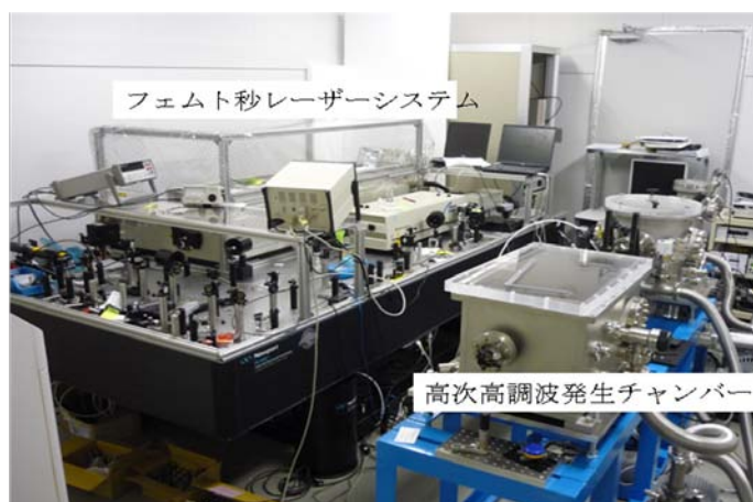
図1 フェムト秒レーザーシステムと高次高調波発生チャンバー
