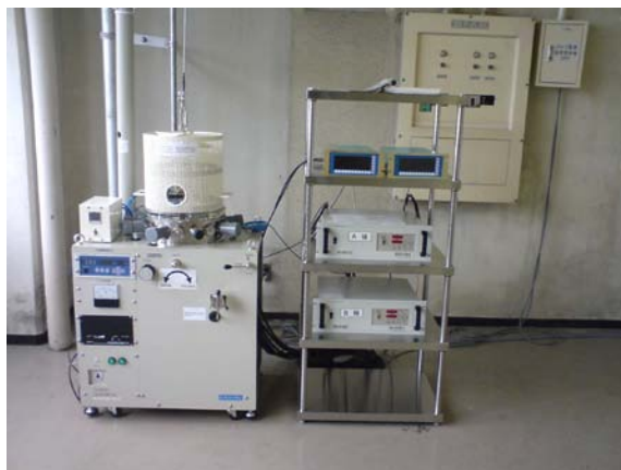
図 B-1 新規導入した共蒸着装置
