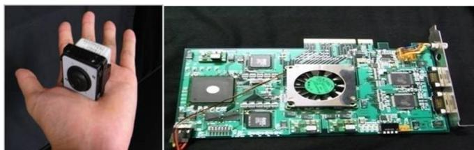
図1. 2,000fps 高速ビジョン試作システム
