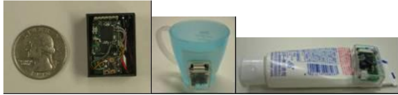
図3. センサノードとそれを添付したカップと歯磨き粉チューブ
