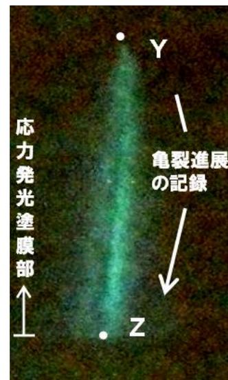
図3 銀塩写真材料を用いた100 $\mu$ クラックへの応力積算記録(積算時間:500s)。最初Y点にあった亀裂先端が、応力印加によりZまで進展していく様子が記録されている。
