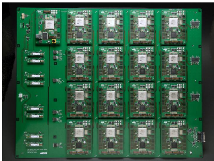
図 8. 耐永久故障用テストベッドボード
