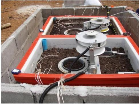
図 1. 土壌呼吸量測定システム
