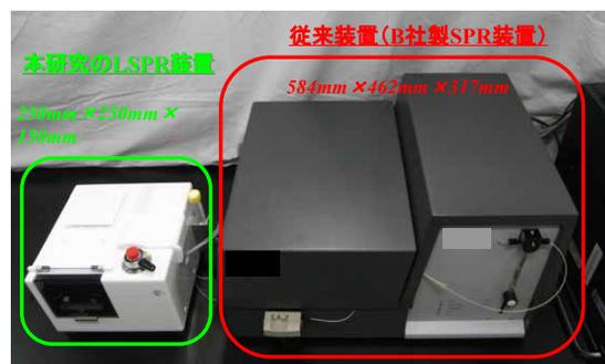
図5. デスクトップサイズのLSPR装置
