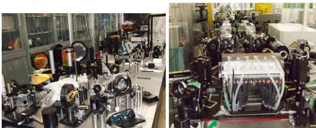
図 4 高出力光パラメトリック増幅の励起源として開発中のピコ秒ガラスレーザー装置. 左：チャープパルス発生部。 右：ジグザグスラブヘッドを用いた 8 パス増幅器。
