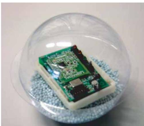
図6：加速度センサを用いた溺れ防止システムの試作器
