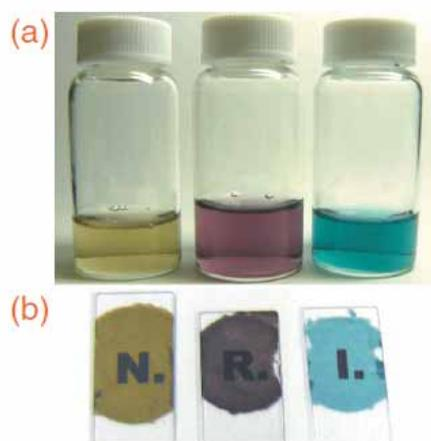
図2 直径の異なる金属CNT分散液
