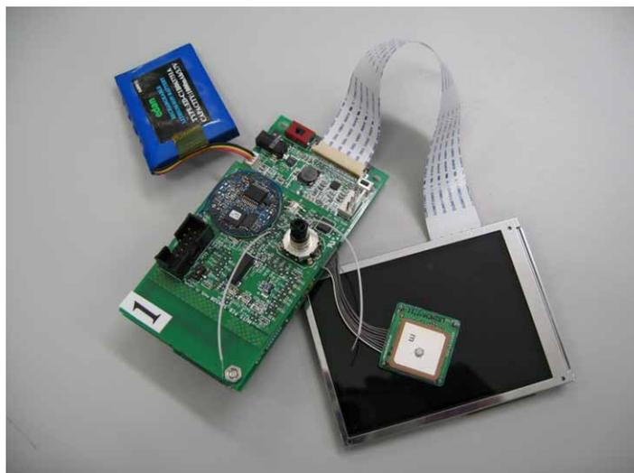
また、開発した NUTS ハードウェアで、組込機器をターゲットとする Linux 動作環境である Open Embedded を動作させるため、I2C を利用した、電源管理のためのデバイスドライバ、センサ情報取得用デバイスドライバの開発および、LCD や Audio のデバイスドライバ変更を行った。これにより、本研究課題のテストベッドハードウェアとしての動作が行える。
