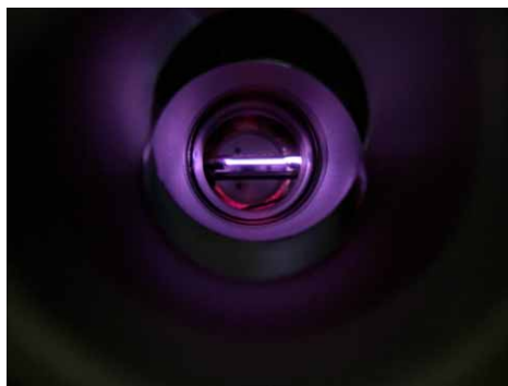
H 2 ガス雰囲気中の Si 基板表面近傍に発生した光電子制御プラズマ (白く発光した領域)
