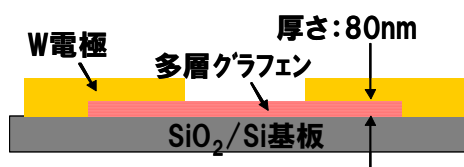
W電極を用いた抵抗評価パターンの断面模式図
