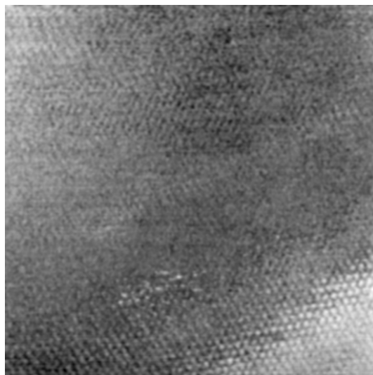
図3. 純水中のマイカ表面で見られる構造. 白い点の最小ピッチは4オングストローム程度である. コントラストの反転が見られる. もやのような部分は絶えず動いていた.
