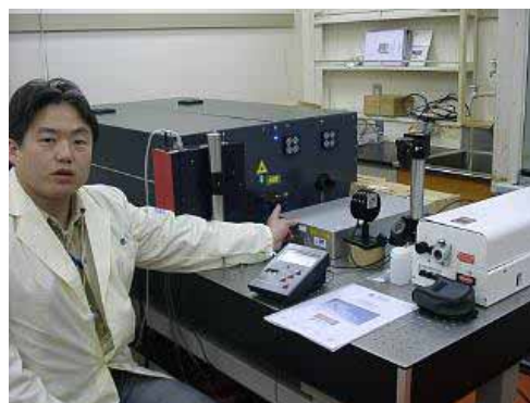
図5 最適イオン化条件探査のための超短パルスレーザーシステム
