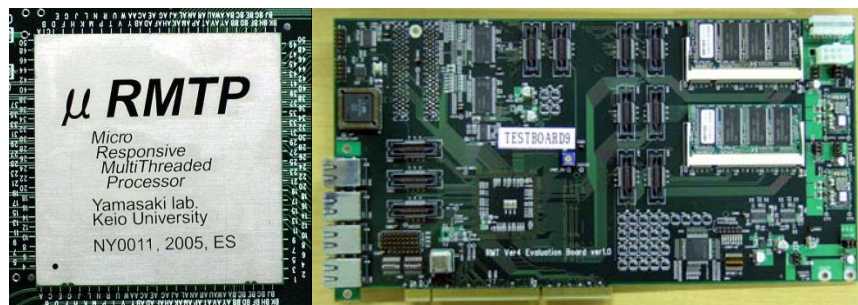
図2 \mu RMTP のパッケージと PCI 評価ボード
