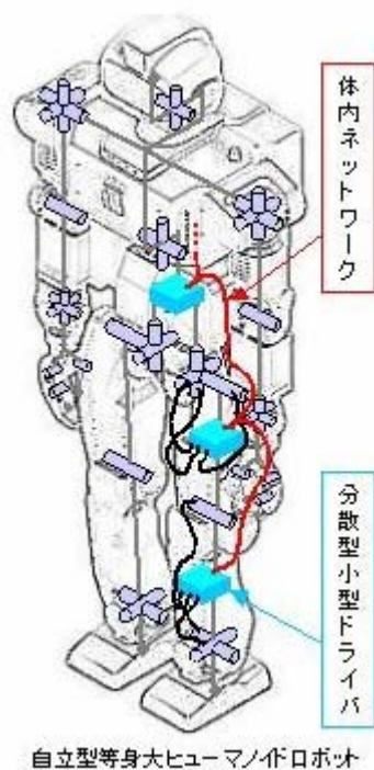
図3 分散型小型ドライバを各リンクに搭載した自立型等身大ヒューマノイドロボット
