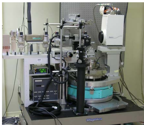
図 2 BL40XU に導入された精密回折計
