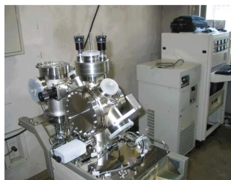
図4. (上) デスクトップマテリアルラボの概念図。直径1.5m程度の領域に3~5個のチャンバーを集積化。実験対象によって、各ユニットの標準化により、おきかえ可能である。(下) 実際に作製した $\mu$ PLDユニット。
