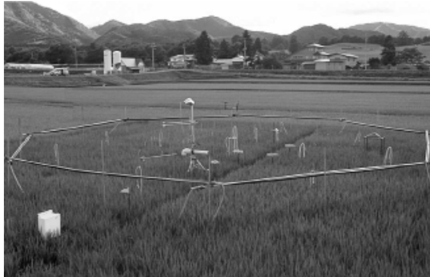
図— 1 開発した純 CO 2 放出型 FACE リングの外観
