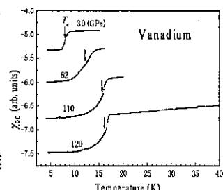
することがわかった。この値は単体金属では現在報告されている中で最高である。右図は各圧力下でのバナジウムの直流磁化率の温度変化である。
