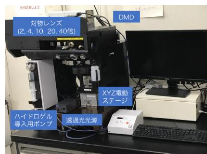
図9. 高精度広視野イメージング/ゲル作製システムの概要
