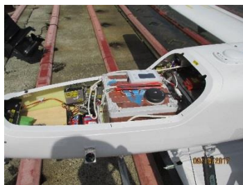
図 3.3.4 無人機に搭載した防水型開発センサ(3.2kg)
