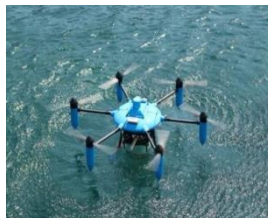
図 3.3.7 陸上(左図)および着水モード(中図)のマルチコプター搭載ハイパースペクトルセンサと佐渡白瀬地先で着水モードにより計測した可視画像(右図)
