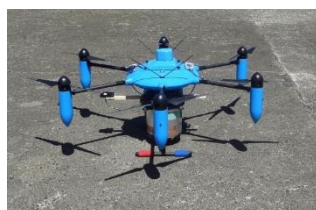
図 3.3.7 陸上(左図)および着水モード(中図)のマルチコプター搭載ハイパースペクトルセンサと佐渡白瀬地先で着水モードにより計測した可視画像(右図)
