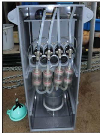
図 3.3-1. 多段階ろ過システム
