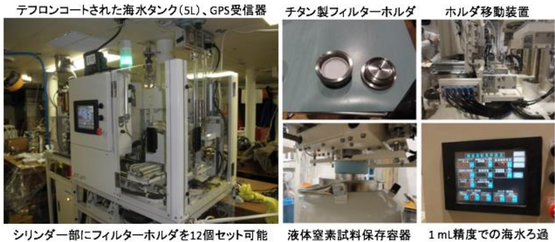
図 3-1 連続自動ろ過システム。
