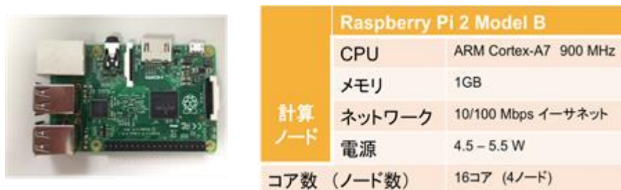
図 5 ACP ライブラリが動作する Raspberry Pi クラスタの仕様構成
