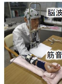
MEMSセンサによる短拇指屈筋の筋音計測
