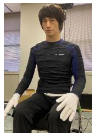
図 1-2 男性型アンドロイドおよびタッチセンサを装着した様子
