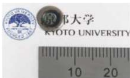
作製した直径 3 mm サイズの構造分離カーボンナノチューブ集積自立薄膜
