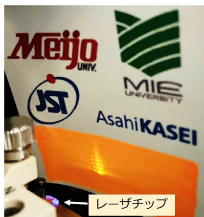
UV-Bレーザの発振の様子 (目で見えない紫外線を目視するために紙に蛍光体を塗ってレーザ光を照射しています)
