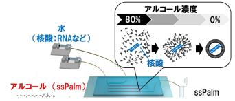
マイクロ流体中における水とアルコールの迅速混合によるナノ粒子調製技術の開発
