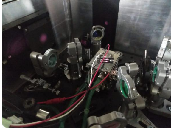
図: 開発された再生増幅器の一部。中央の光っている部分が増幅媒質のトリウム固体結晶である。
