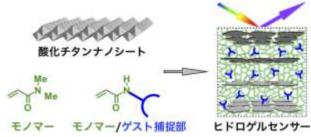
フォトニック結晶をヒドロゲルへと変換し、なおかつゲスト捕捉部位を導入する手法が確立された。
