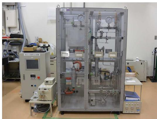
図 2. 高圧水素発生装置(100 MPa 仕様への改良)
