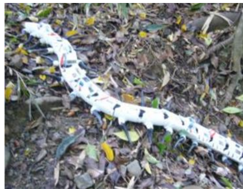
図 1. ムカデ型ロボット i-CentiPot 1,2
