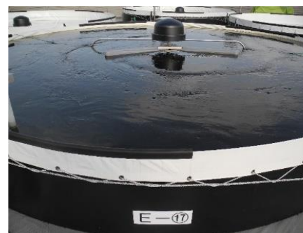
図 3. オープンポンド型屋外培養実証装置(10,000 L クラス)
