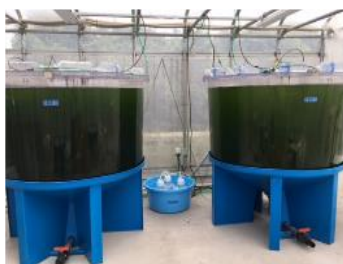
図 1. 一次処理水+汚泥可溶化液を使った藻類培養装置 1)
