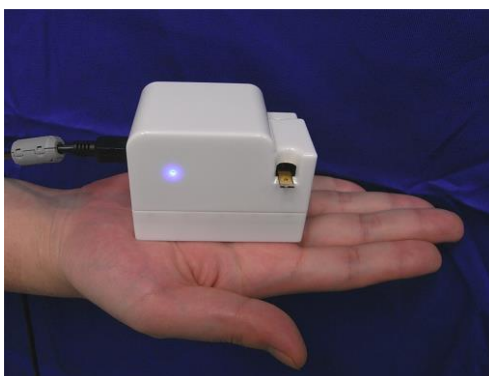
図 3-5 手のひらサイズの小型 SPR システムの外観 24
