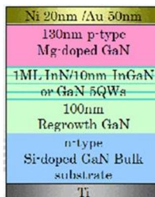
図 3-20 1 分子層 InN ナノ構造を発光層とした青緑 LED の構造例
