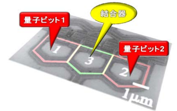
図6. 可変結合器により結合された超伝導の2量子ビットの回路
