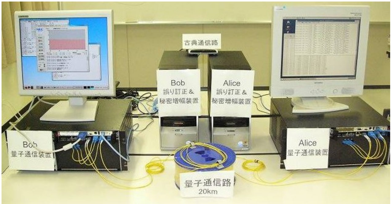
図 4.5 鍵蒸留のためのソフトウェアを実装した量子暗号鍵配布システム
