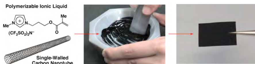
図 18. カーボンナノチューブとイオン液体の複合化とポリマー化による自立薄膜の形成。
